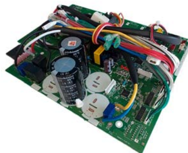
PLACA DE CONTROLE DA CONDENSADORA AR CONDICIONADO FUJITSU -...
