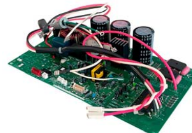
PLACA DE CONTROLE DA CONDENSADORA AR CONDICIONADO FUJITSU -...
