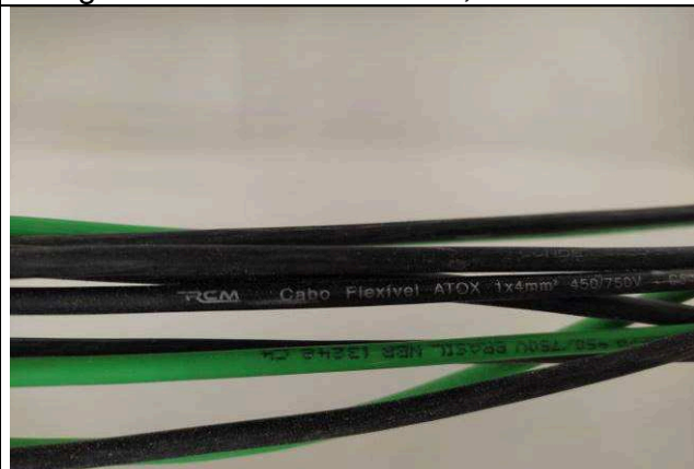
Figura 06E: cabeamento 4,0mm 2 4ª VT
