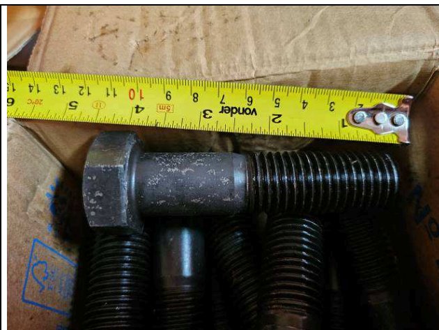
Figura 22: Estrutura metálica barrilete – parafuso de ancoragem.
