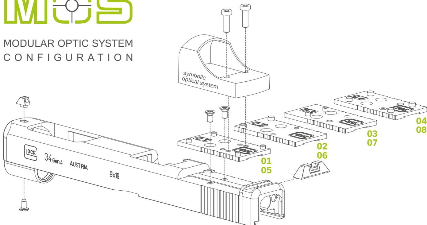
Os engenheiros da GLOCK desenvolveram o Sistema Ótico Modular - MOS para simplificar a montagem de miras óticas de diversos fabricantes. A configuração MOS é a escolha ideal para acertar seu alvo.
