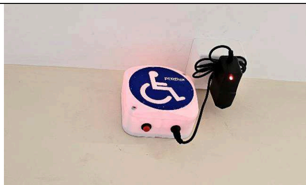
Figura 84: Unidade externa do alarme antipânico - PNE.
