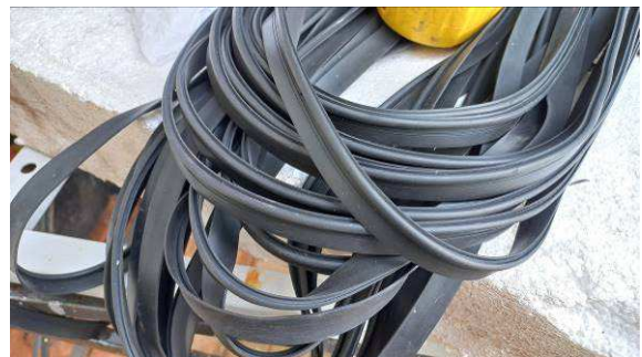
Figura I.3.14C: Detalhe da gaxeta FAA-250, antes de sua instalação
