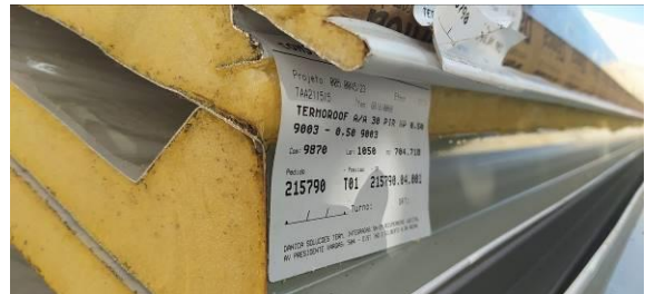
Figura I.2.4C: Etiqueta informativa das dimensões e características técnicas da telha Termorooft
