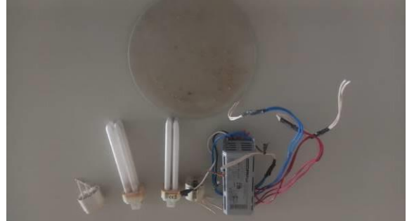
Figura I.6.2E: Substituição soquetes, limpeza luminária e novas lâmpadas LED
