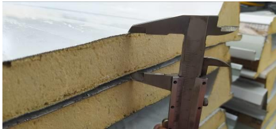
Figura I.2.1C: Aferição da espessura do enchimento da telha
