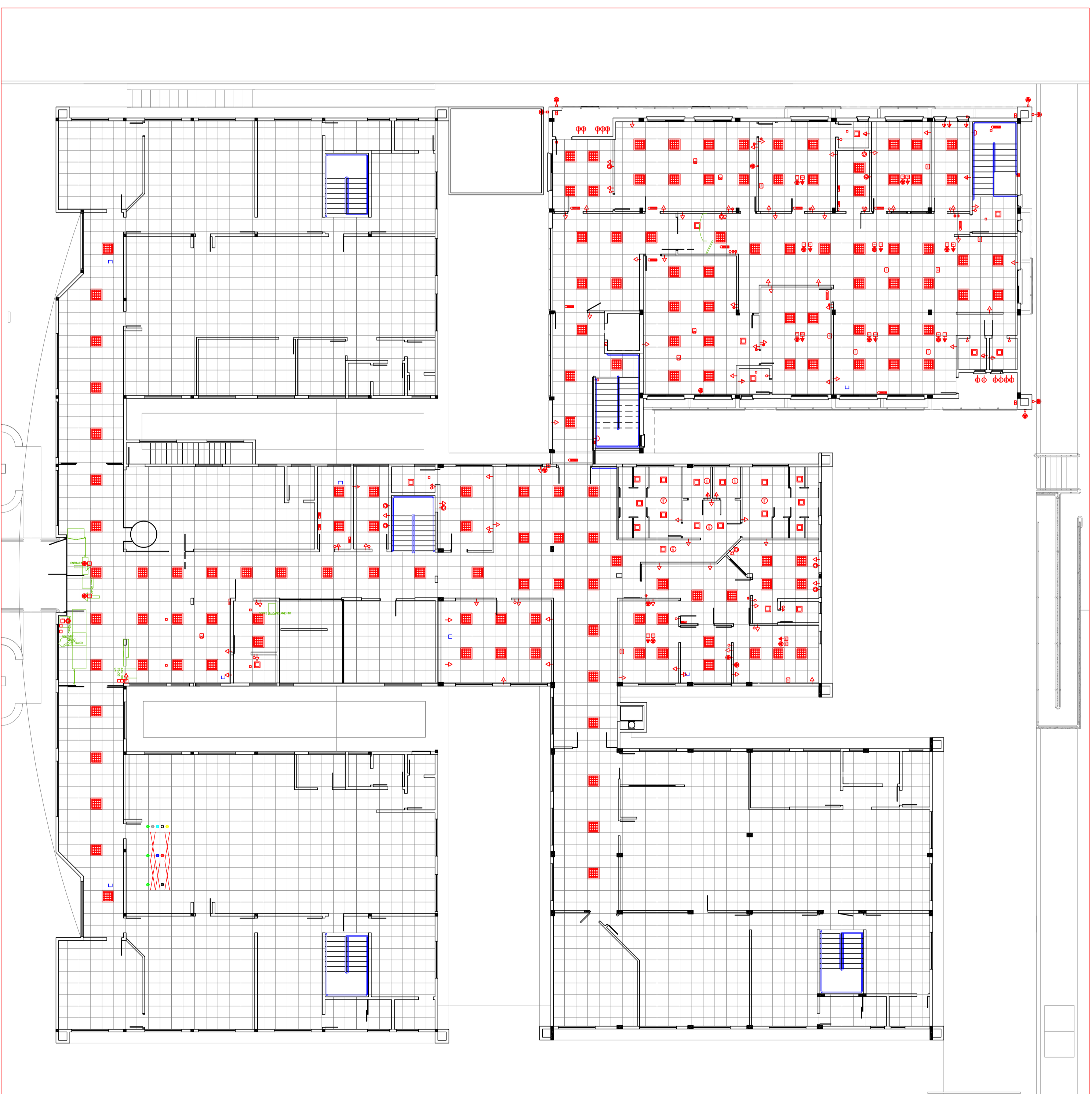
Modulação do forro e luminárias Escala 1:150
