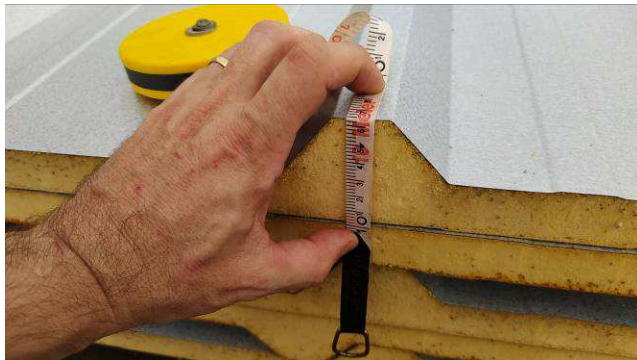
Figura 19C: Aferição da altura total da telha
