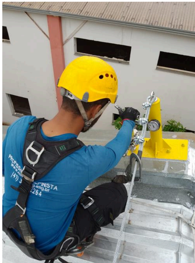
* Exemplo de um ponto sendo testado com carga de tração de 500kg
