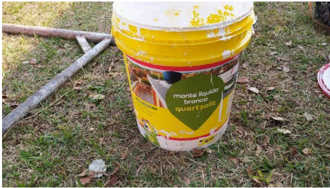
Figura 27C: Produto impermeabilizante aplicado nas marquises
