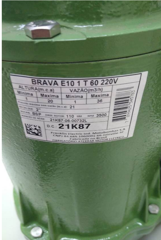
Figura 01E: motobomba submersível marca Schneider Eletic/Franklin Eletic modelo Brava E10
