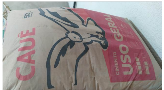
Figura 36C: Cimento CP-II 32, utilizado no traço do piso de concreto do subsolo
