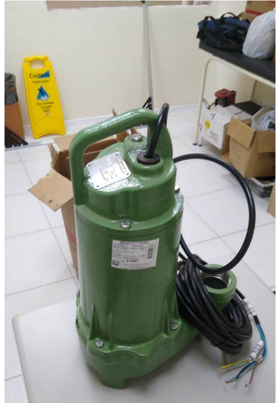
Figura 02E: motobomba submersível marca Schneider Eletic/Franklin Eletic modelo Brava E10
