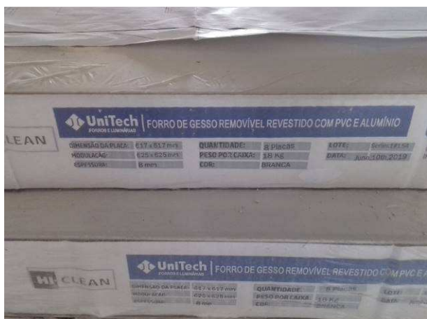
Figura 03C: Caixa com placas de forro em gesso acartonado revestido
