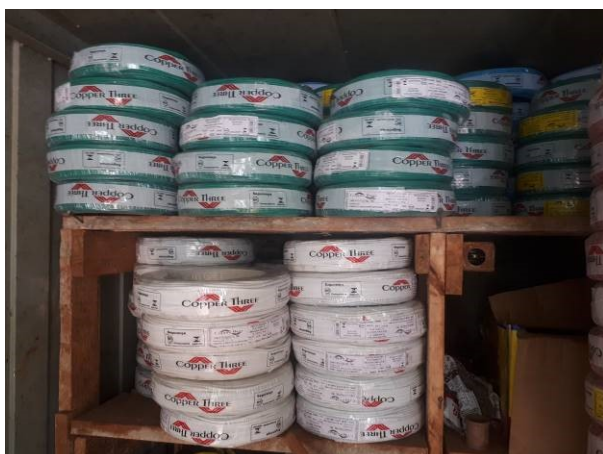
Figura 13E: cabeamento elétrico 2,5mm 2
