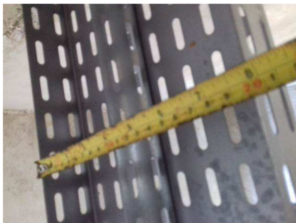
Figura 10E: Aferição da largura de eletrocalha U #200x50
