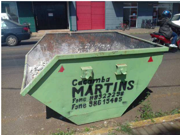
Figura 01C: Caçamba para remoção de entulho
