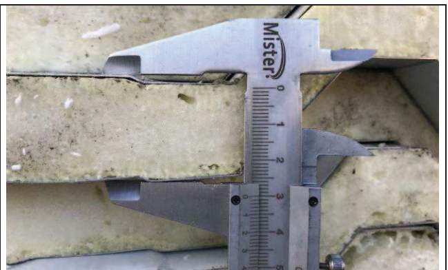
Figura 08C: Telhas metálicas com injeção de 30mm de poliuretano.
