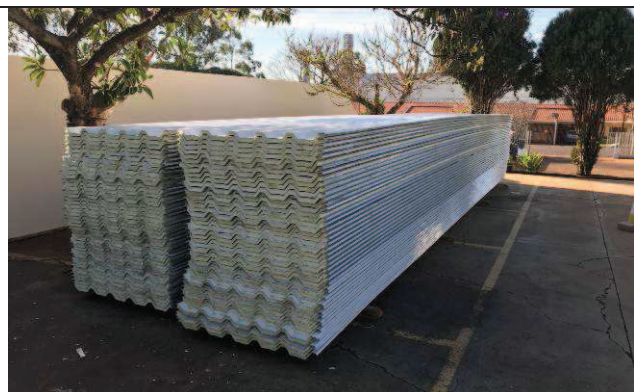
Figura 07C: Telhas metálicas com injeção de poliuretano.
