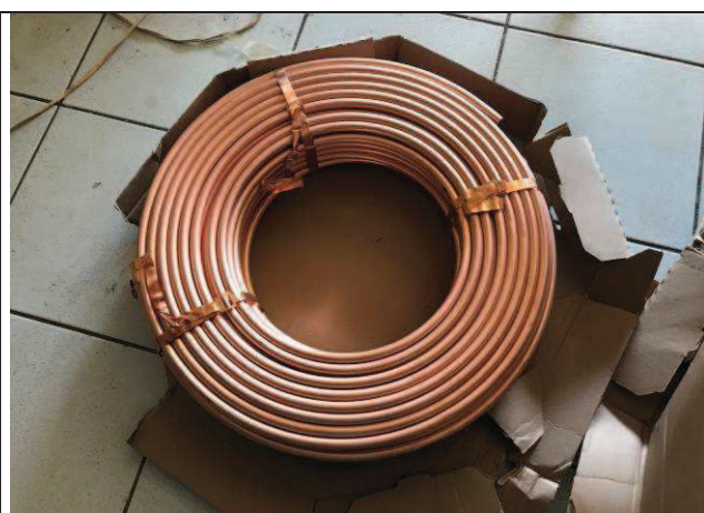
Figura 77C: Tubos de cobre - rede frigorígena.
