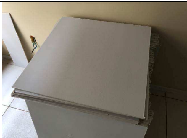
Figura 35C: Revestimento em PVC das placas de forro.
