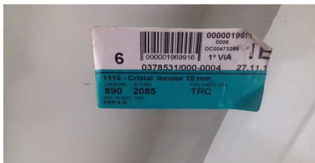
Figura 10C: Detalhe do vidro 10mm
