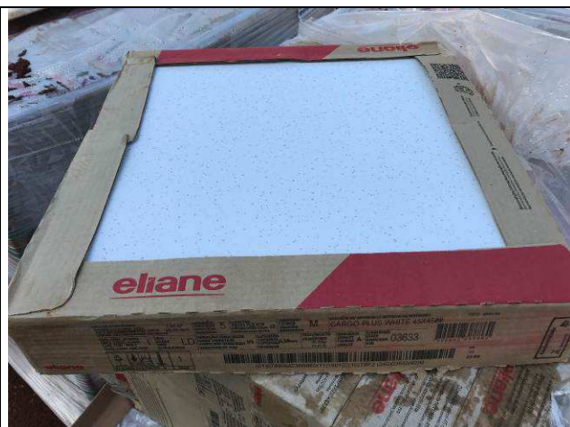
Figura 23C: Pisos cerâmicos utilizados - Cargo Plus White 45x45 - Eliane.
