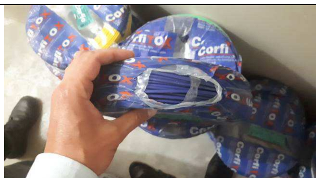
Figura 17E: Cabeamento elétrico #2,5mm² - Marca Corfio linha Corfitox
