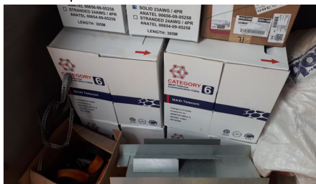
Figura 54E: cabeamento lógico UTP cat6
