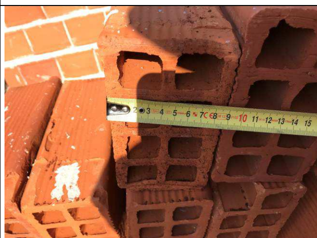
Figura 68C: Tijolo utilizado para as paredes do muro.
