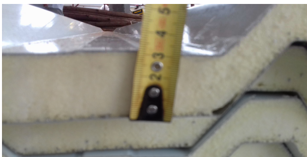
Figura 16: Aferição da espessura do enchimento
