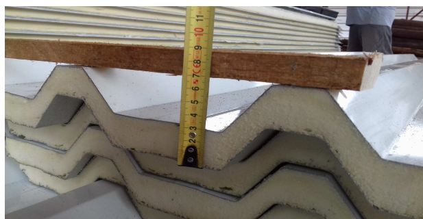
Figura 15: Aferição da altura da telha
