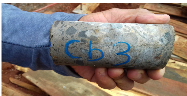
Figura 17: Corpo-de-prova removido, com indicação do caminhão-betoneira (o terceiro, no caso) referente à amostra. A retirada das amostras foi 100% efetiva, pois não houve necessidade de qualquer refazimento de amostra. Não houve atingimento de armadura longitudinal e tampouco ruptura da amostra durante a retirada
