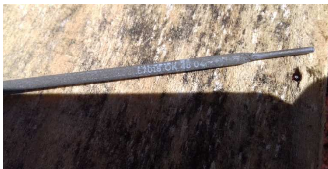
Figura 9C: Eletrodo utilizado, conforme recomendação do parecer técnico (E7018 AWS)
