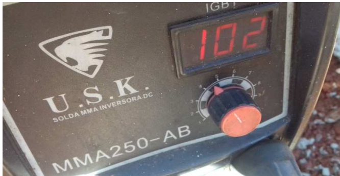
Figura 7C: Soldador de eletrodo sendo calibrado para atingir a temperatura mínima de trabalho, para evitar de solda e dos espaçamentos entre cordões. Os valores destempero da armadura e, ao mesmo tempo, garantir a perfeita fusão entre o metal-solda e a armadura. A amperagem ideal foi a de 100A, para o eletrodo adotado.
