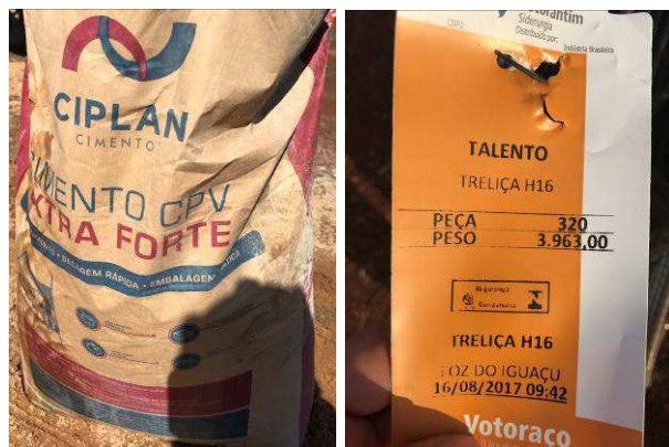
Figura 70C: Cimento CP-V e treliças utilizadas nas vigotas treliçadas das lajes.
