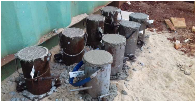
Figura 11: Corpos-de-prova de concreto, retirados durante a concretagem das estacas
