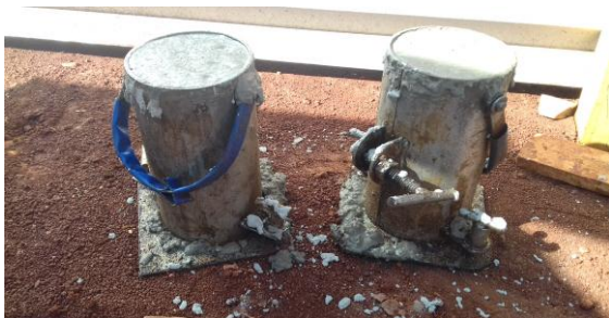
Figura 21: Retirada de 2 corpos-de-prova para cada caminhão entregue
