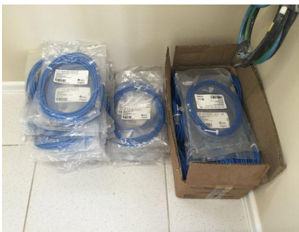
Figura 24 . 19 patch cords de 1,5m para ativação dos pontos e de 3m para conexão microcomputadores
