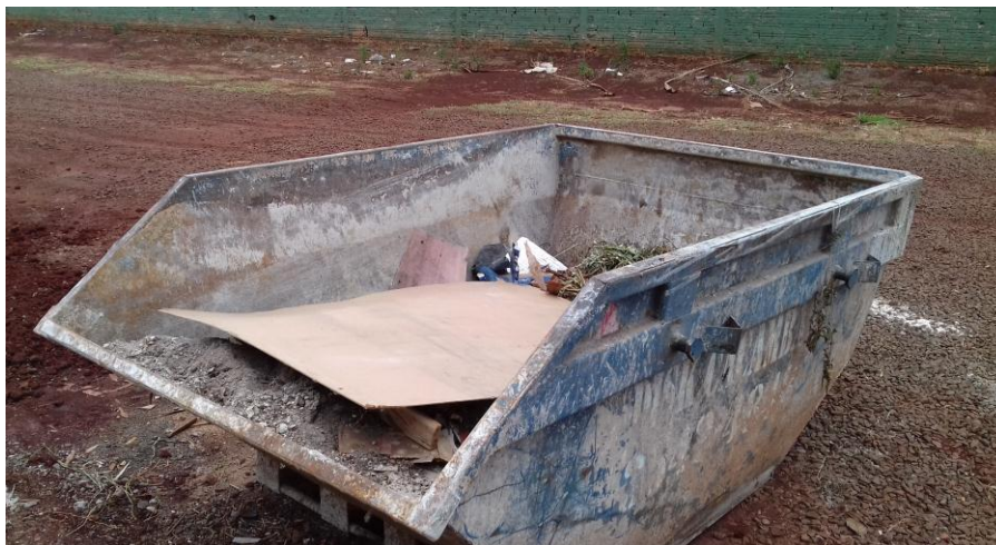
Figura 2.1: Caçamba de remoção de entulhos
