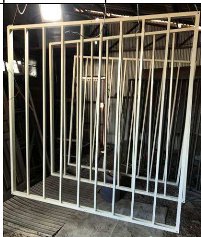
Figura 19C: Grades metálicas - Pintura com pistola - Janelas J01.
