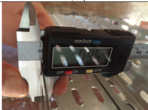
Figura 19E: Eletrocalhas - espessura - chapa # 20.
