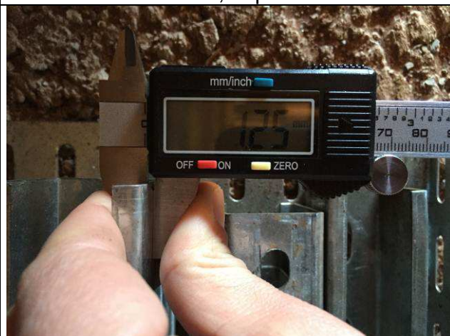
Figura 20E: Perfilados - espessura - chapa # 18.
