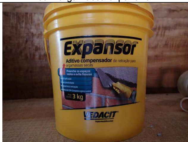
Figura 45C: Aditivo expansor utilizado na argamassa de encunhamento.
