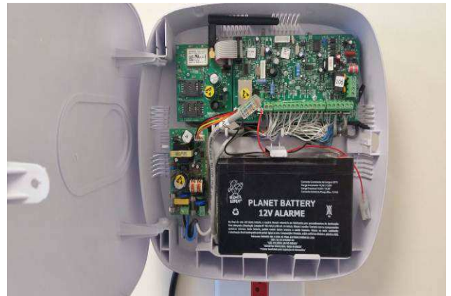
Figura 102E: Central de alarme Intelbrás 2018EG
