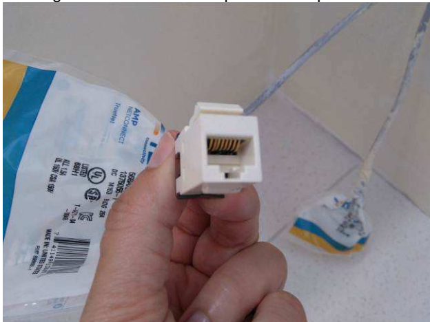
Figura 75E: conectores cat6 AMP - 1º pavimento
