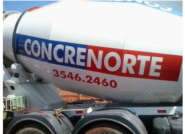
Figura 32C: Empresa fornecedora do concreto usinado para concretagem das estacas
