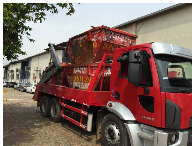
Figura 18C: Caçamba utilizada para armazenamento e transporte de resíduos da obra.
