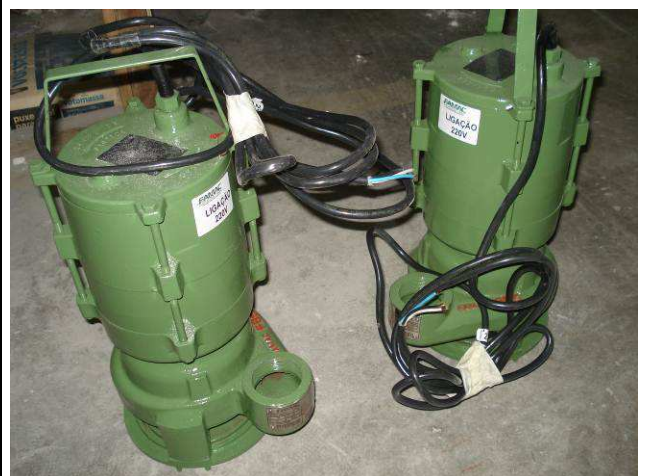
Figura 180C: Instaladas 2 moto-bombas submersíveis trituradoras, marca Famac.
