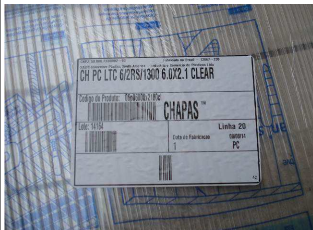
Figura 162C: Policarbonato alveolar 6mm utilizado na cobertura.
