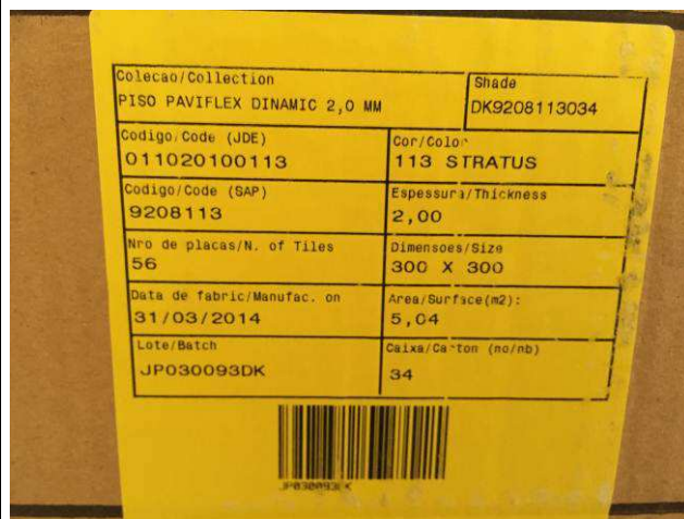
Figura 58C: Piso vinílico utilizado – Paviflex Dinamic.
