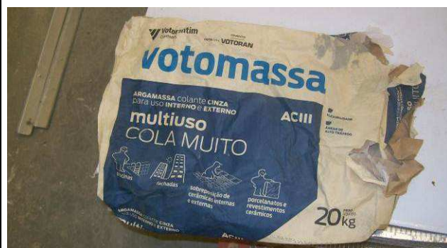
Figura 76C: Argamassa AC-III – assentamento dos azulejos nas paredes de gesso acartonado.
