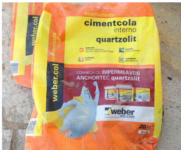
Figura 93C: Argamassa colante para assentamento de piso cerâmico, marca Weber.
