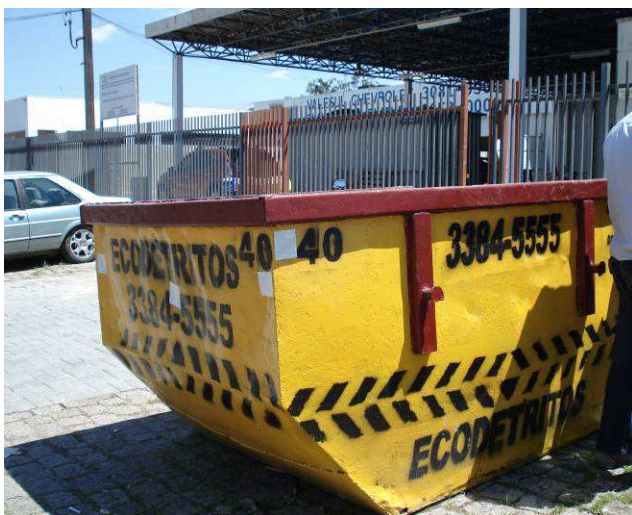
Figura 06C: Caçamba para coleta de entulhos.
