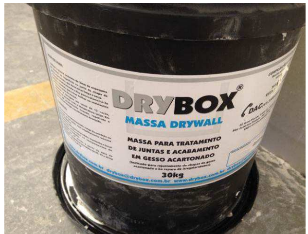
Figura 17C: Massa utilizada para tratamento das juntas das placas de gesso acartonado.
